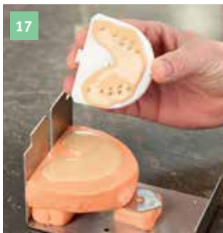
17 Porre la piastra zoccolo a faccia in giù sul supporto e immergerla.
