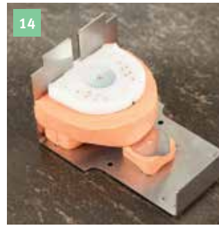
14 Dopo aver inserito i perni, eseguire un controllo ponendo la piastra zoccolo sull'impronta.
