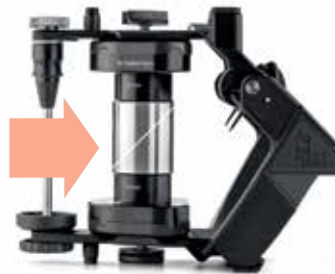
Articolatore difettoso: fessura chiaramente visibile
