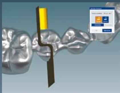
Posizionamento del taglio digitale tridimensionale con la funzione Bridge Split
