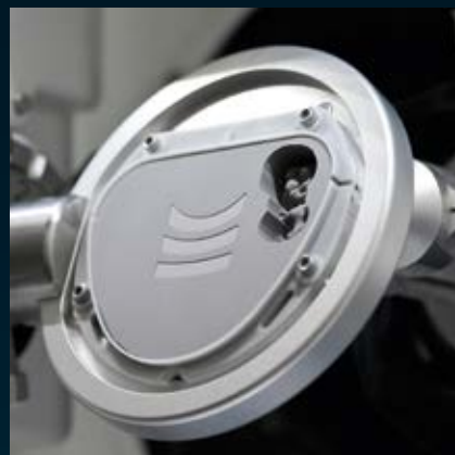
3 Fresaggio del restauro dal grezzo Ceramill Sintron (Ceramill Motion 2 o Ceramill Mikro)
