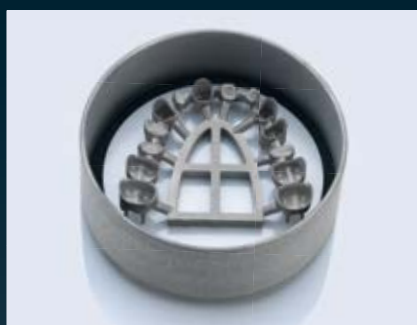
Struttura fresata sul Float Sintering Disc nel Ceramill Argovent
