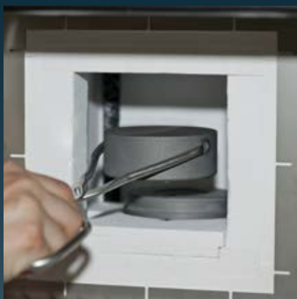
5 Posizionamento nel forno della vaschetta di sinterizzazione con coperchio
