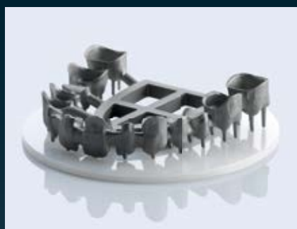
Ponte di Ceramill Sintron con lunga arcata sostenuto da perni e barre di supporto
