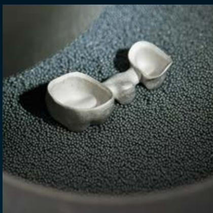
7 Struttura di Ceramill Sintron dopo la sinterizzazione e rimozione dal forno Ceramill Argothem 2
