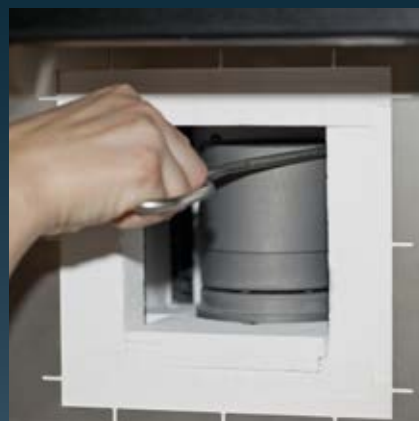
6 Posizionamento della storta di sinterizzazione e inizio del procedimento
