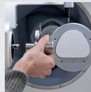
Facile cambio del portagrez- zo per passare da fresaggio a molaggio
