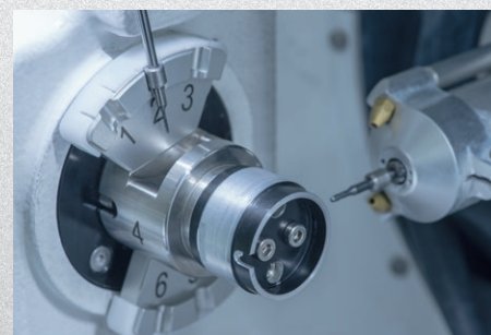
La calibrazione di precisione garantisce il corretto allineamento di abutment e geometria di connessione dell'impianto
