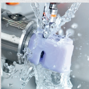
Nella modalità "Carving" il materiale in eccesso viene separato in blocco
