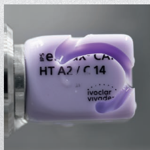
Nella modalità "Carving" il materiale in eccesso viene separato in blocco
