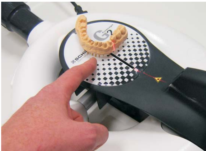
Zahnkranz an der letzten Karoreihe ausrichten und Schnittposition über den Laser anpeilen. Allineare l'arcata sul ultima linea di quadrati neri e puntare la linea di taglio con il laser.
