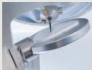
Lavorazione a 5 assi (anche simultanei) con ampie e sufficienti vie di rotazione per indicazioni del futuro (modelli, protesi totale, ecc.).
