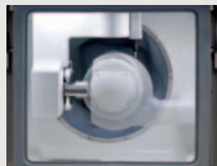
Vasca d'aspirazione per una migliore capacità d'aspirazione, minimizza l'entrata della polvere nella macchina durante la lavorazione a secco.
