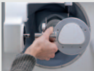
Semplice sostituzione del portagrezzo per il cambio della lavorazione refrigerata a quella a secco.
